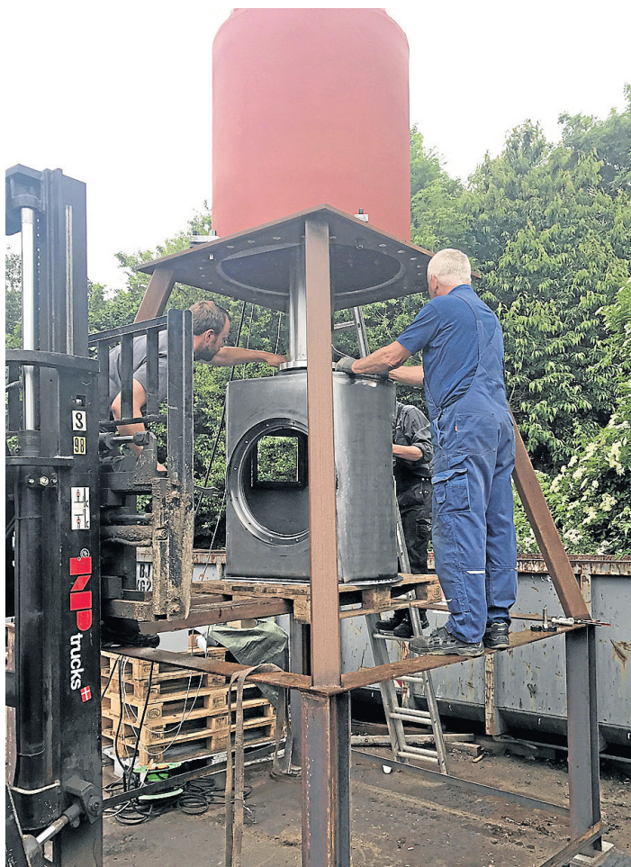
Her gennemføres en factory acceptance test af udstyret i Danmark. Her ses den hejseinstallation, der skal kunne skyde en Kongsberg MS70 ud gennem skroget. Foto: Bill Endersen
