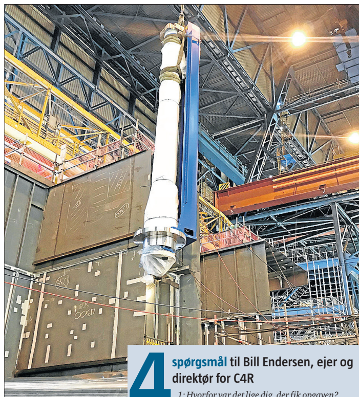
En Farsounder-sonar hoist på vej til at blive monteret i skibet i november 2017. Foto Bill Endersen
